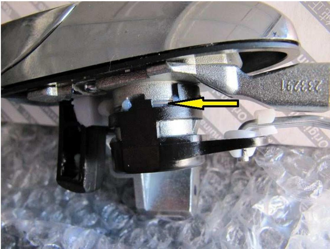
**Schlüssel einstecken (nicht in die Jackentasche 😊) in Richtung Aufschliessen drehen und Schliesszylinder rausziehen. Einbau in neuen Griff ging ohne Sicherungsring zu entfernen. Neuen Griff in umgekehrter Reihenfolge wieder einbauen. 2 Std. sind rum und fettich.**
