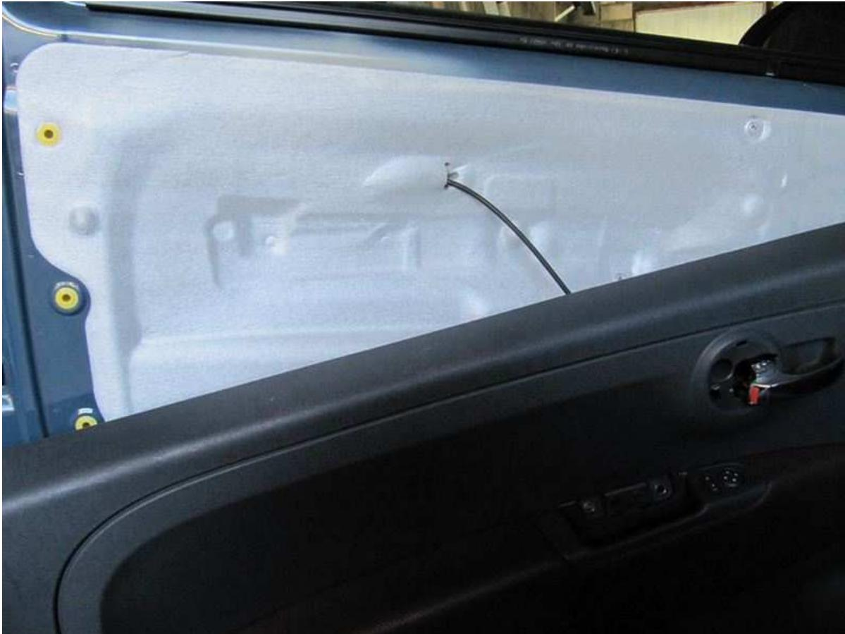
**"Wasserschutzfolie" im Schlossbereich entfernen, ich hab sie nachher wieder mit Tape angeklebt.**
