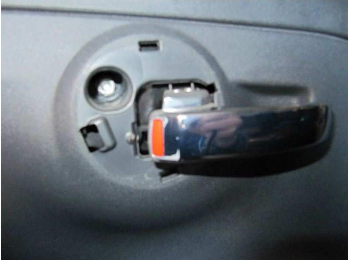
**Dann kann die Innenverkleidung abgezogen werden, vorsichtig erst links, rechts und unten die Verkl. aus den Klipsen hebeln und dann nach Oben anheben (ist im Fenstergummi nur eingehängt. Damit man sieht welchen Abstand die Klipse ungefähr haben ->**
