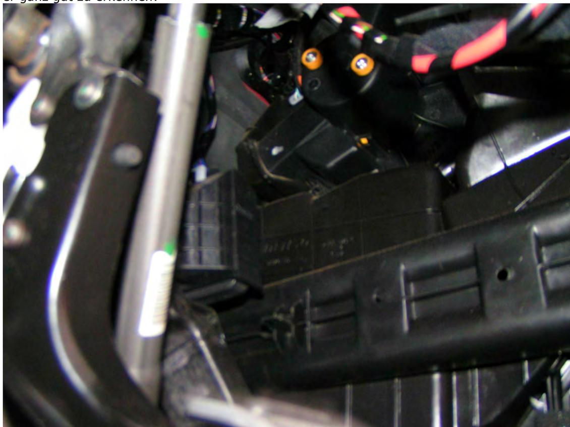
Die beiden orangenen Punkte gehören zum Lüftermotor (nicht abschrauben!). Unten Rechts sieht man die Schraube, welche man lösen muss, um den Lüftermotor auszubauen. Der Pfeil zeigt auf die zu lösende Schraube
