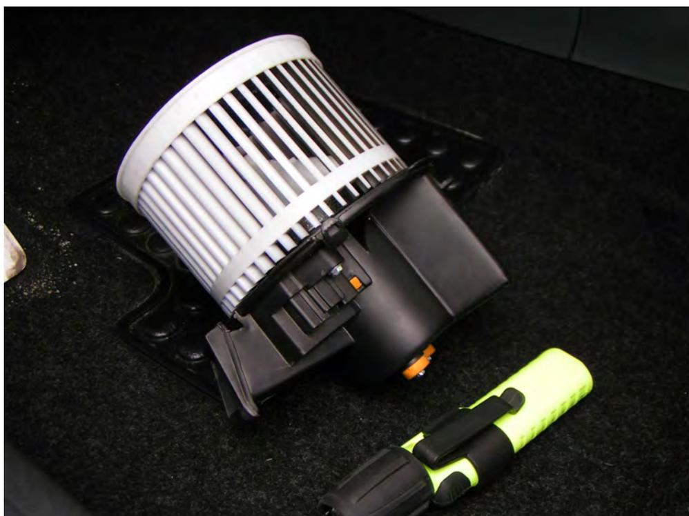
Um den Motor zu öffnen, müssen die beiden Schrauben mit den orangen Gummi-Unterlegscheiben vollständig gelöst werden.
