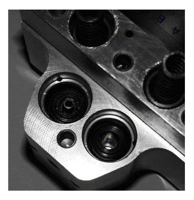
jetzt noch die Elektromagnete einsetzen, auf die Bohrung unten in den E-Magneten achten, die Feder muss da hinein.
