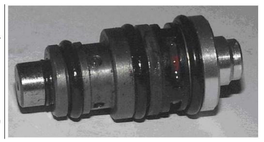
Einsetzen der Pumpe ins HDU Gehäuse, mit dem Kolben zuerst. Bitte auch hier leicht einfetten.
