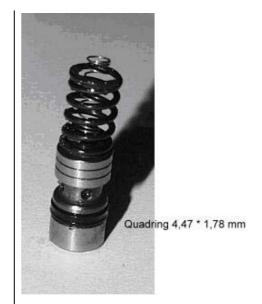
So sieht die Pumpe komplett zusammengesteckt aus und das müssen wir noch einmal machen für vorne und hinten. Bitte auch hier keine Gewalt anwenden. Die Einzelteile sind passgenau gefertigt, so das sie ohne Kraft anzuwenden in einander passen. Auch hier leicht einfetten.
