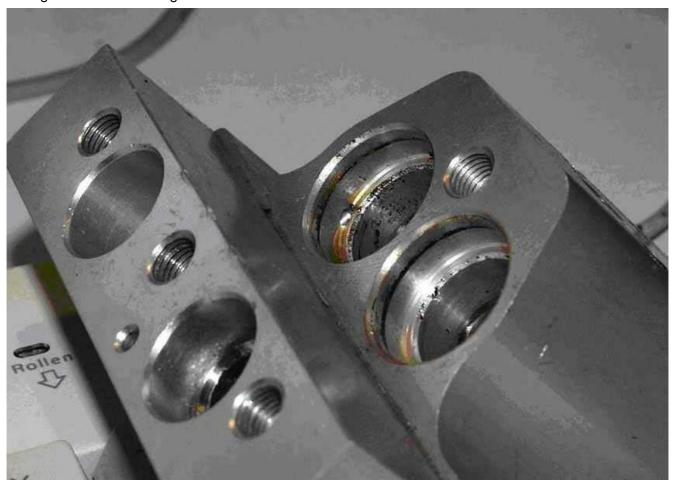
Gereinigt habe ich die Bohrungen mit einem Schleifvlies. (Bitte kein Schmirgelpapier, auch noch so fein, verwenden) Darauf achten, dass keine Rückstände in den Löchern verbleiben, evtl. mit Pressluft ausblasen, auswaschen usw.. Danach mit Bremsfett dünn einfetten.
